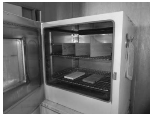
写真1-4 100℃急速乾燥試験の様子
