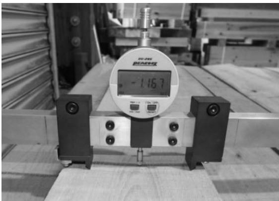
写真 1-6 カップの測定と製材木取り位置による様々なカップの様子
