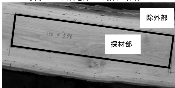
写真4-1 虫孔を除いた場合の採材
