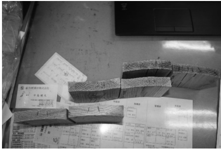
写真 3-3 100°C急速乾燥試験断面変形
