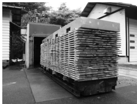
写真1-3 21mm厚ミズナラ板材人工乾燥の様子
