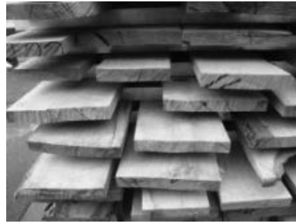
写真 1-8 木口割れの様子
