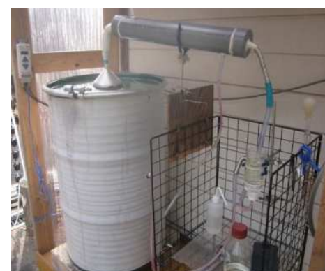
ドラム缶を用いて開発した精油採取機
