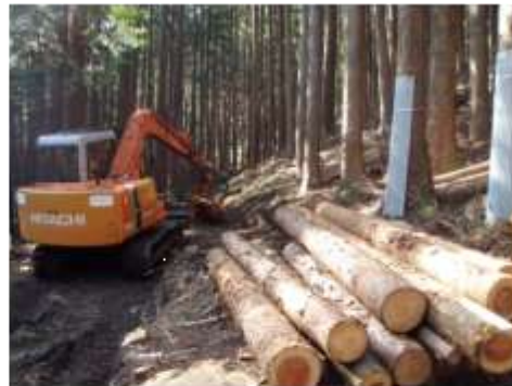
上松町：立木をトタンで保護しながら間伐材を搬出
