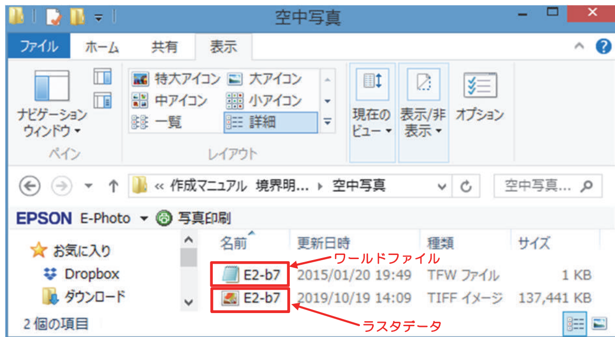
図 II-26 Windows Explorer の画像（ラスターデータ） （ワールドファイル付与のラスターデータの構成）
