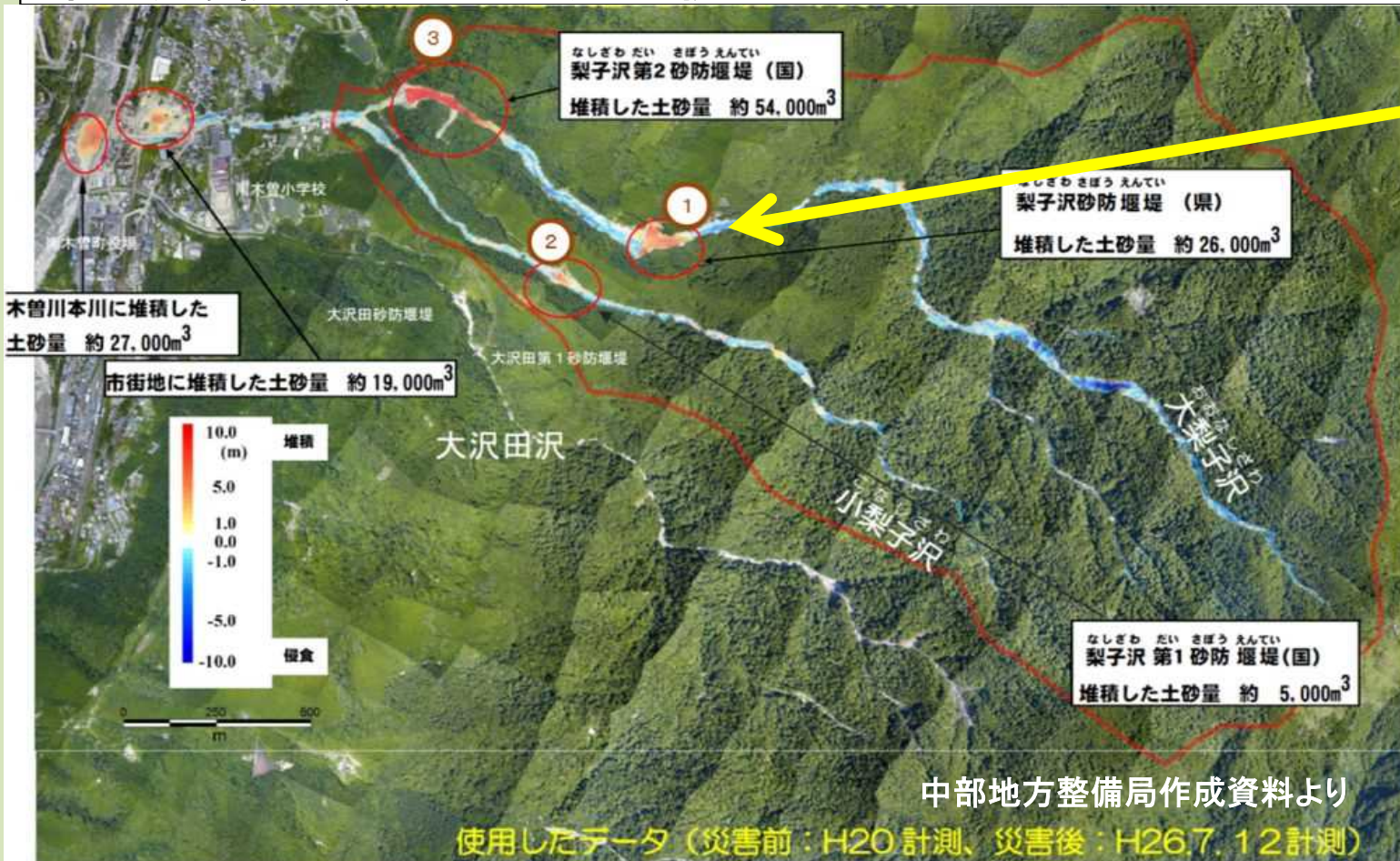
梨子沢砂防堰堤 S46完成 H=20.0m L=123.7m
