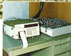
集中管理システムに整備された 31ヶ所の伸縮計
