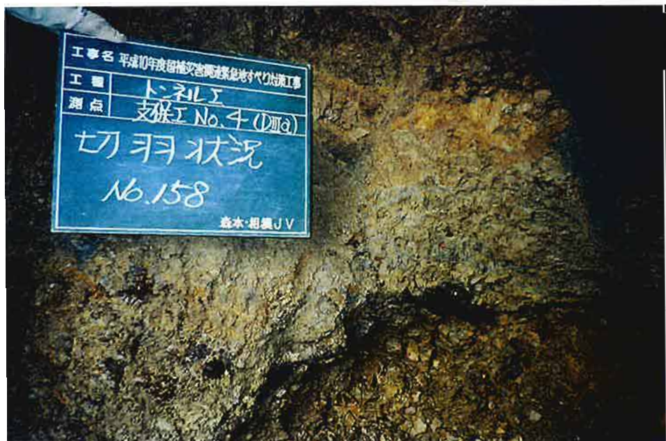
写真-4 切羽No.158 の拡大写真。凝灰岩岩片の周囲には砂質から粘土質のマトリックスが充填されている。
