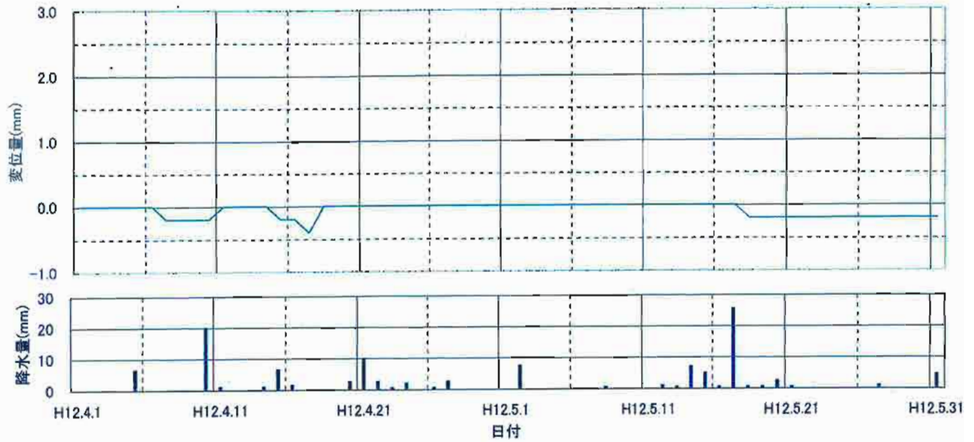
図4-3 下石川地すべり地表伸縮計E変位グラフ (平成12年4月1日～平成12年5月31日)
