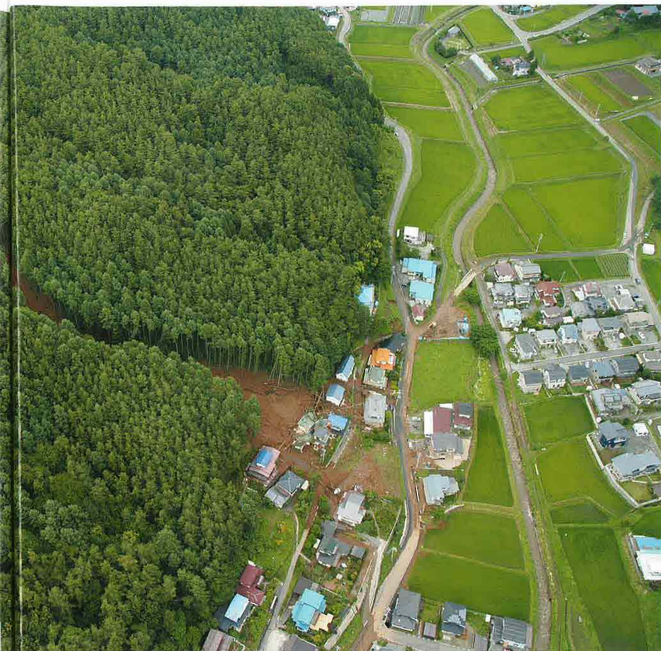
土石流による被害状況
