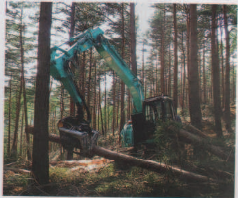
枝を取り払い、木材を一定の長さに切るプロセッサ
