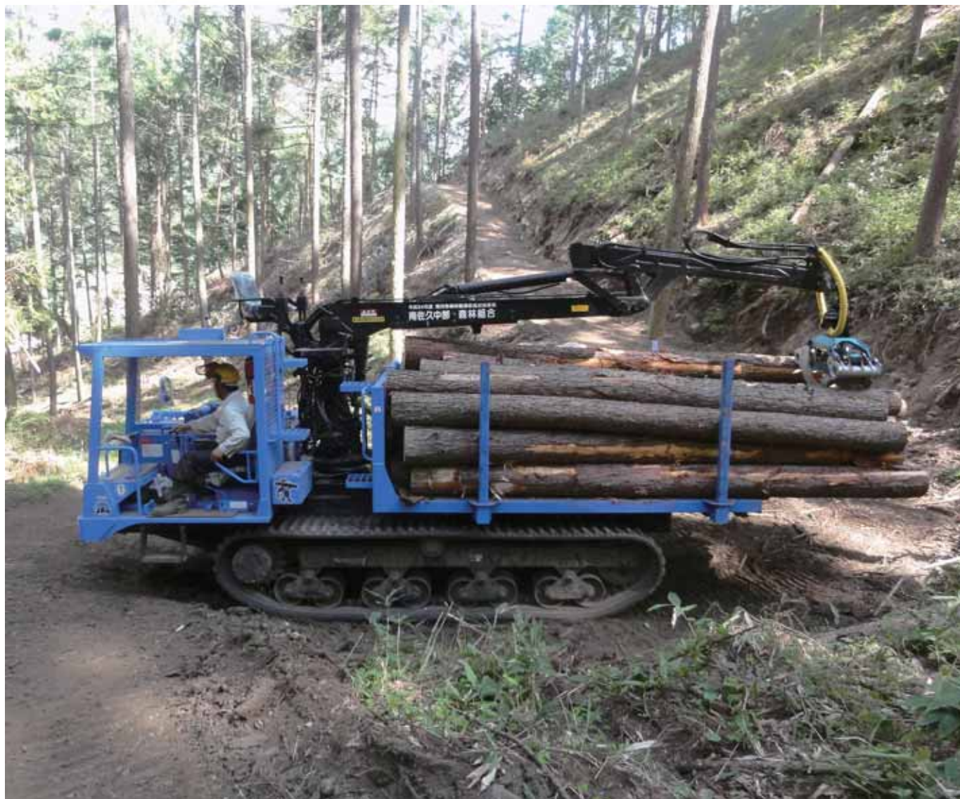
間伐材を搬出する高性能林業機械「フォワード」
