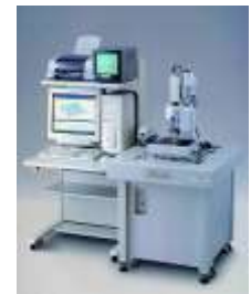
▲レーザー光による非接触で高精度 (100 万分の 1mm 単位) な測定が可能
