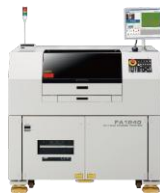
フライングプローブテスタFA1240 基板と電子部品の接続不良検出
