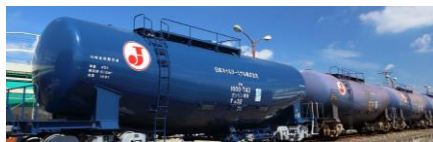
日本オイルターミナル殿 石油製品輸送用タンク車（60kL）
