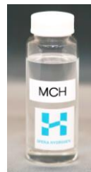
常温常圧で安定した液体として 水素を保持できるMCH
