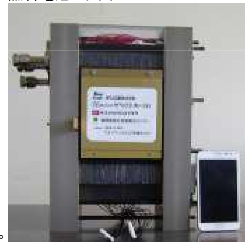
金属セパレーターを100セル積層した燃料電池スタック
