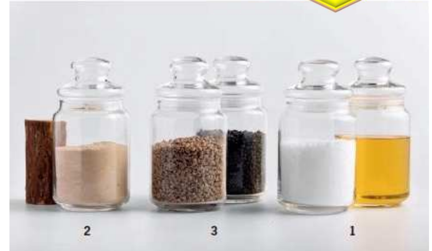
トランスウッド(3) 長野県産間伐材の粉末(2)/ポリプロピレン(1)
