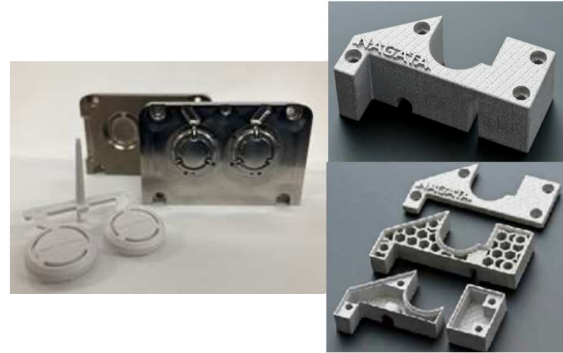
製品事例:左:成形金型、右:内部空洞の形状
