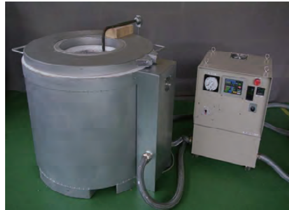
溶解炉本体と電源装置
