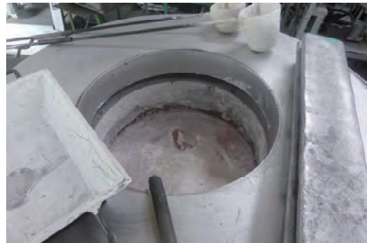
アルミを溶解した状態。溶解したアルミを炉内で一定温度に保持することが可能。
