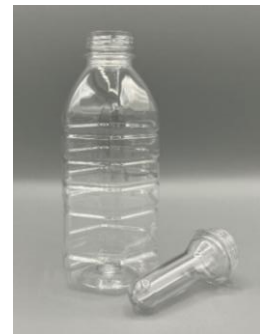
FR-24型で生産したボトルと、膨らませる前のプリフォーム
