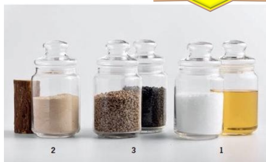
トランスウッド(3) 長野県産間伐材の粉末(2)/ポリプロピレン(1)
