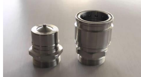
スパコン「富岳」の冷却装置の接合部品。重要部分を担う
