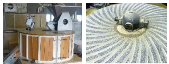
石臼製粉機（手前1m径、奥1.5m径） 石臼内部下臼（固定）
