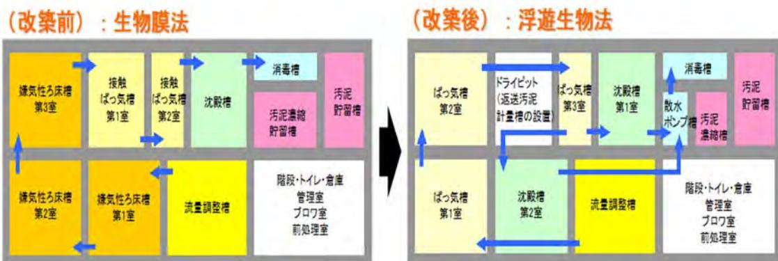
図2-6 切替改築による処理方式の変更
