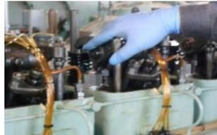
部品欠損し代用品で供用している原動機
