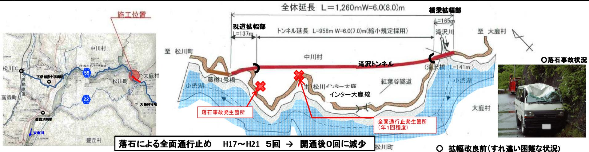
**落石による全面通行止め H17～H21 5回 → 開通後0回に減少**
