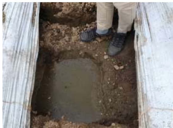
【平谷村】排水不良ほ場（きゅうり）における土壌断面調査実施。水が湧き、翌日には水が穴の縁まで来ていた。（10月20日）
