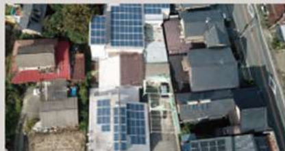
有限会社和泉庄 松尾工場 飯田市松尾 / 出力27.5kw, CO 2 削減量 / 18,380kg-CO 2 /kwh
