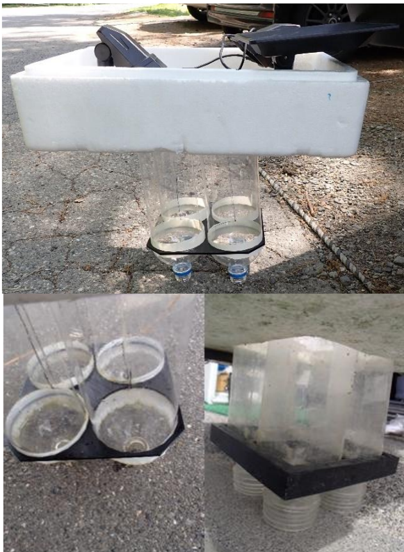
図3 簡易ライトトラップ丸型全体図(上)と3Dプリンター活用部(丸型:左下、四角型:右下)
