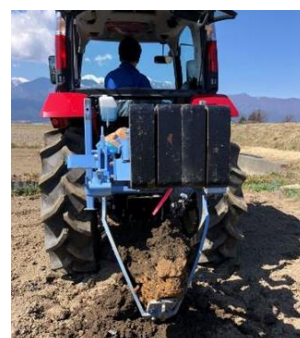
写真13 カットブレーカー
