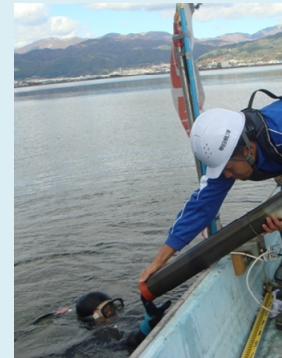
図3：柱状採泥作業状況写真と湖底状況写真
