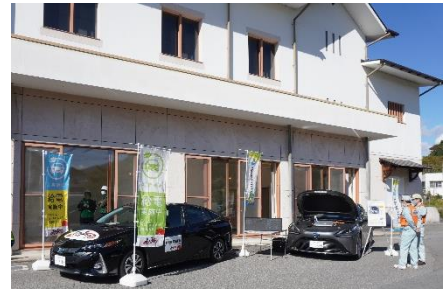
車両から外部給電器を介して給電する様子 (令和5年度長野県総合防災訓練)
