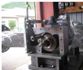
県内企業が開発する小型小水力発電機
