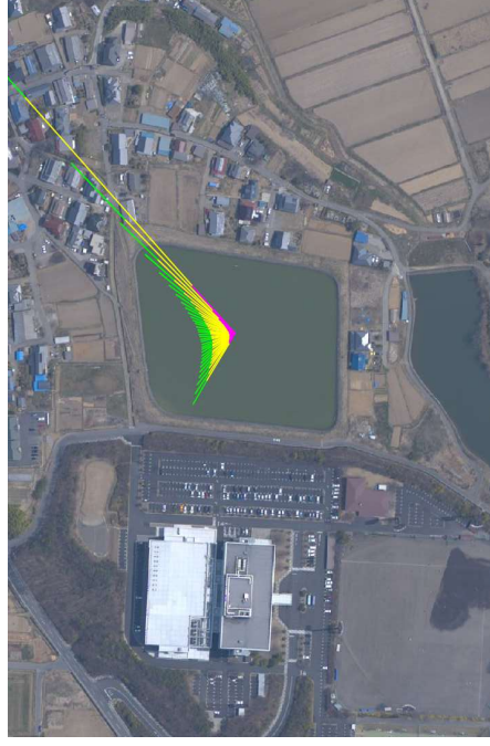
パネル方位西 傾斜 8度
